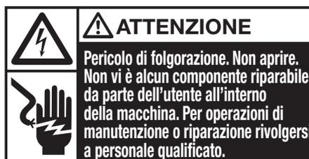
Questo messaggio di sicurezza segnala la presenza di gravi pericoli, anche mortali, in caso di apertura della macchina e conseguente esposizione a correnti ad alta tensione.
